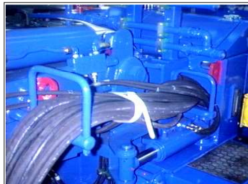
Vista dei punti di sollevamento posizionati sul lato sinistro macchina View of the lifting points located on the left side of the unit
