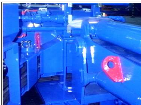
Vista dei punti di sollevamento posizionati sul lato destro macchina View of the lifting points located on the right side of the unit
