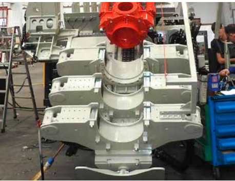
BRACCETTO CARICA ASTE SU TESTA DI ROTAZIONE. Ø DI PRESA: 45 - 220 MM PIPE LOADER ARM ON ROTARY HEAD. CLAMPING RANGE: 1" 3/4 - 8" 11/16 in
