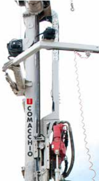
DISPOSITIVO DI SOLLEVAMENTO PER ASTE E TUBI DI RIVESTIMENTO. RODS AND CASING LIFTING DEVICE.
