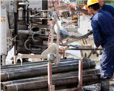
DISPOSITIVO DI SOLLEVAMENTO PER ASTE E TUBI DI RIVESTIMENTO. RODS AND CASING LIFTING DEVICE.
