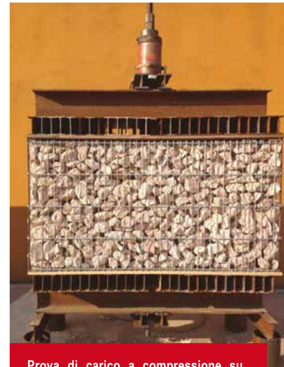
Prova di carico a compressione su gabbione singolo Single gabion compression test
