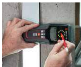
Modalità metallo: per rilevare ferri d'armatura
