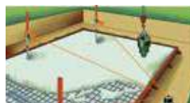
Determinazione dell'altezza delle fondamenta.
