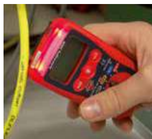
Rilevatore di tensione alternata senza contatto integrato.
