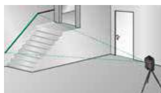
Funzione manuale con il tasto blocca pendolo
