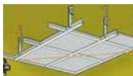
Montaggio di controsoffitti.
