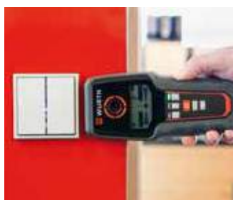
Rilevamento cavi sotto tensione
