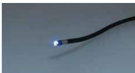
Sonda con 4 led d'illuminazione
