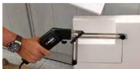
Fig. 6, slitta a L per incassi
