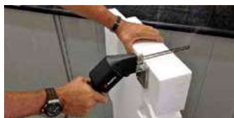
Fig. 1 + Fig. 3, lama dritta 160 mm e supporto direzionale regolabile
