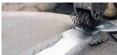
larghezza 23 mm - Art. 0703 350 1 spessore filo d'acciaio 0,70 mm
