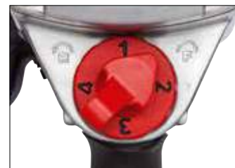
Facile impostazione della coppia di serraggio e cambio veloce della rotazione
